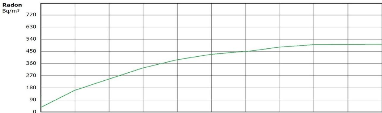
Abbildung 3: Messung der Radon-Aktivitätskonzentration im Unterdruckverfahren bis zur Gleichgewichtskonzentration (Rn<sub>50</sub>-Wert)
