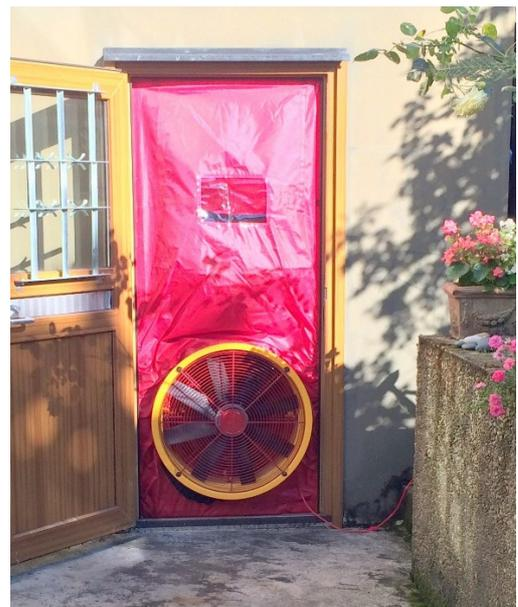
Abbildung 1: Schema für den Rn<sub>50</sub>-Test im Differenzdruckverfahren
