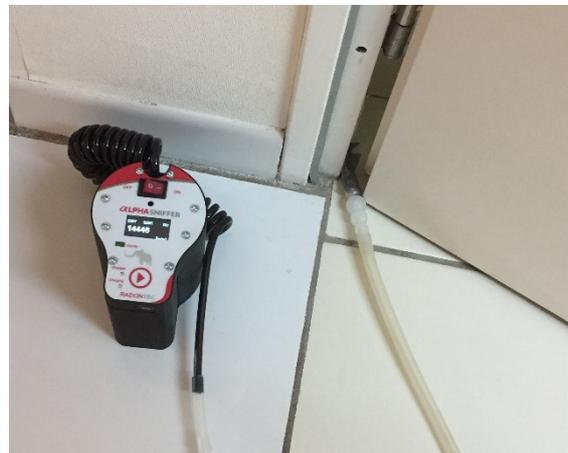
Abbildung 5: Radon-Sniffing an der Türzarge Kellerboden
