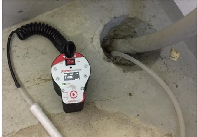
Abbildungen 6 und 7: Radon-Sniffing unter Revisionsklappen und an Durchführungen am Kellerboden im Unterdruckverfahren
